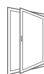
Poignée en haut : fenêtre ouverte en posi- tion française, accessible uniquement avec la clé.
